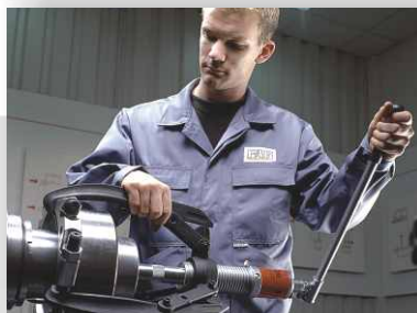
Desmontagem de Rolamentos
