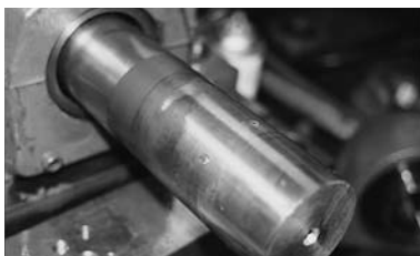
Rolamento com trava de parafuso após 500 horas
